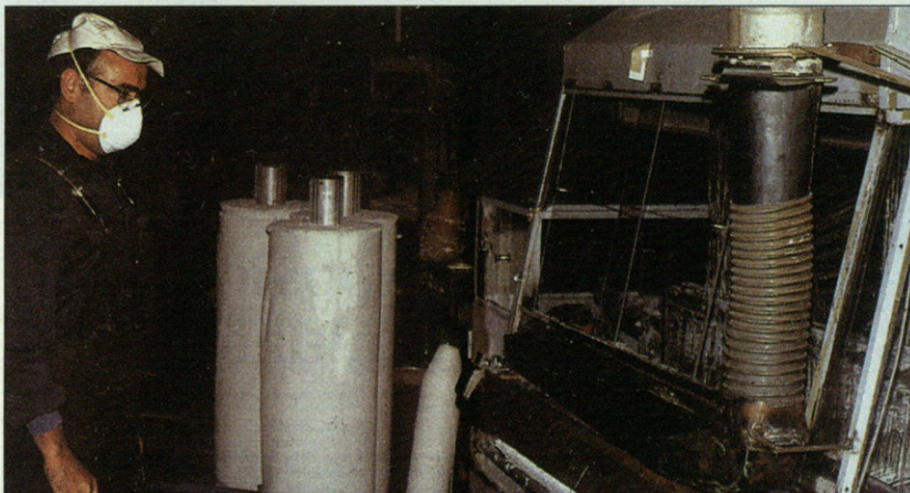
Oraindik ere, langile askok amiantoak kutsatzeko arrisku handia du. Argazkian, lanpostu horretan, amianto zuntzak airean diren ala ez neurtzen ari dira.
