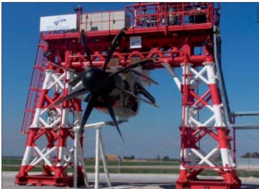
Sener aeronautika enpresan motorrak frogatzeko simuladore bat.
