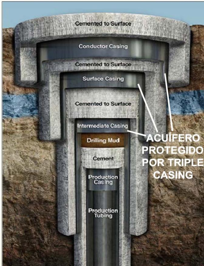
En la perforación de cualquier tipo de pozo para investigación de hidrocarburos, los acuíferos se protegen con varias tuberías (cuatro o tres) y varias capas de cemento (tres o dos)
